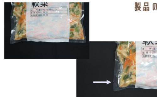
アイフーズで使用している包材(製品袋)は工場設立前から包材業者と打合せを繰り返し、現在の仕様になりました。稼働前は実際にどのくらいの食材を袋に入れて、どの位置にシールを行うのが不明確だったため、どの位置でも真空包装時にシールができるよう、シールをする上側ではなく下側に切り口を設けています。その他の工夫としては、印字の文字がよっきり読めるように中央部を白地にカスタムしていたり、食材の重量によって6種類のサイズの袋を使い分けています。
